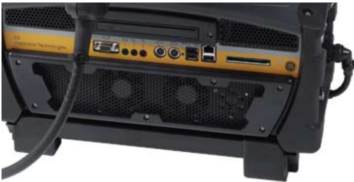
1小时或2小时容量电池/不间断电源使设备不受现场供电限制
