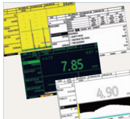
适合每个人的视图：大型 A 扫描、数据记录器、厚度、B 扫描。
