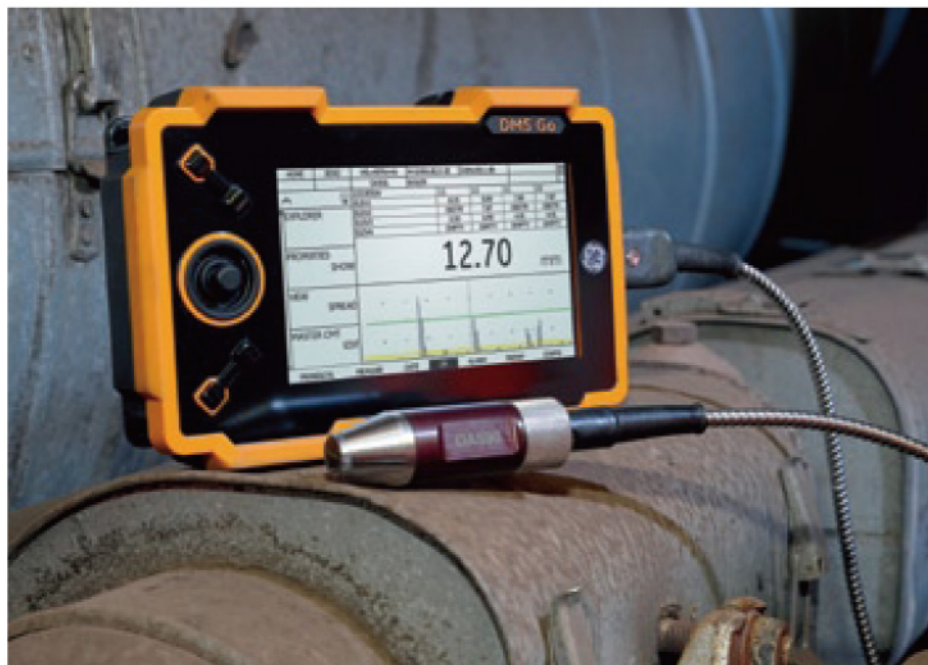
适合每个人的视图：大型 A 扫描、数据记录器、厚度、B 扫描。
