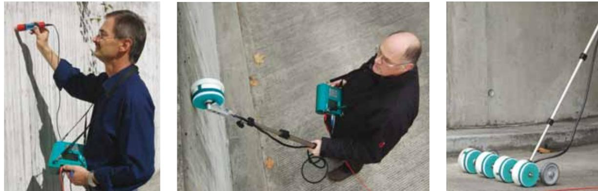
根据单个可选网格尺寸，CANIN<sup>+</sup>十分适用于评估8,000m<sup>2</sup> (83,000 平方英尺)等较大面积甚至几倍大面积区域的锈蚀电位。指示装置内可以储存 235,000 数值。可以通过易读的灰色刻度同时显示多达 240 个测量值，并可以对读数进行现场的真实性和检查。只需九个按键就可以方便地进行菜单操作。带有背光灯的显示屏方便用户在低能见度的工地使用，例如地下停车场。
